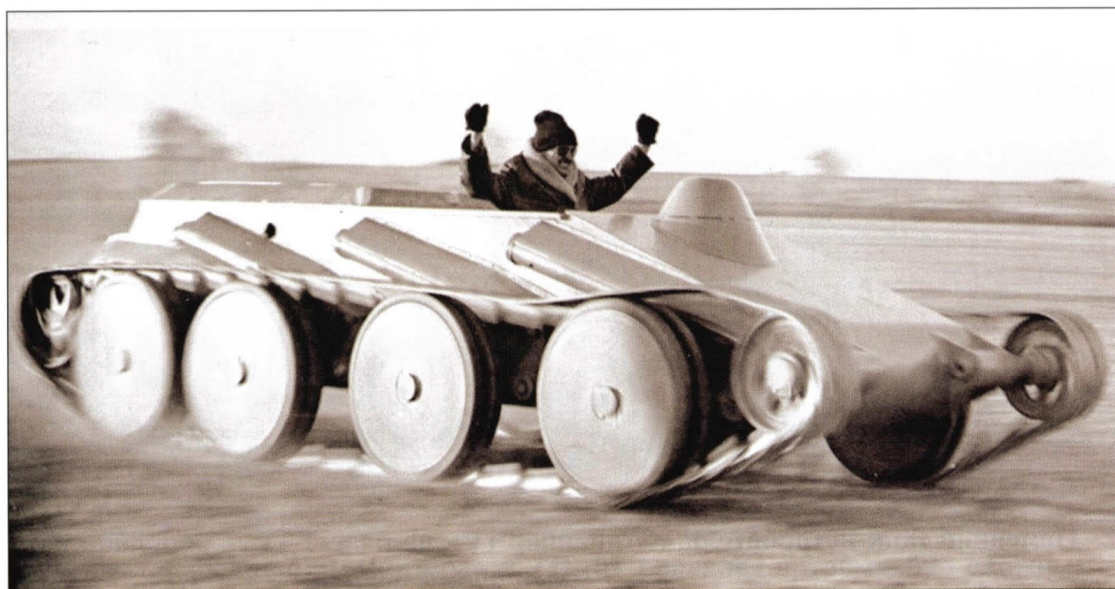
Колесно-гусеничный танк БТ-2 со снятыми гусеницами. На снимке видно, что передняя пара колес – управляемая
