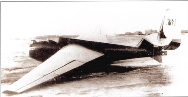
Планер РП-318 с реактивным двигателем в хвостовой части фюзеляжа
