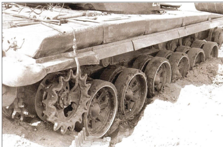
Танки Т-62 (вверху) и Т-72 можно буксировать и без гусениц
