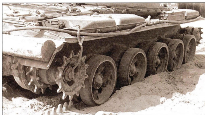
Узкие катки Т-64 малого диаметра при потере гусеницы глубоко врезаются в грунт, что затрудняет буксировку танка
