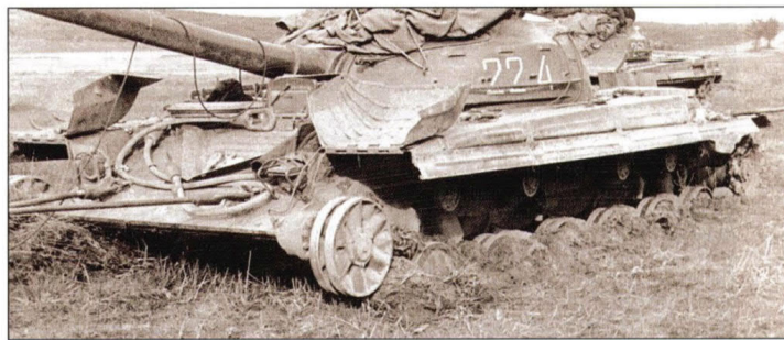
Узкие катки Т-64 малого диаметра при потере гусеницы глубоко врезаются в грунт, что затрудняет буксировку танка
