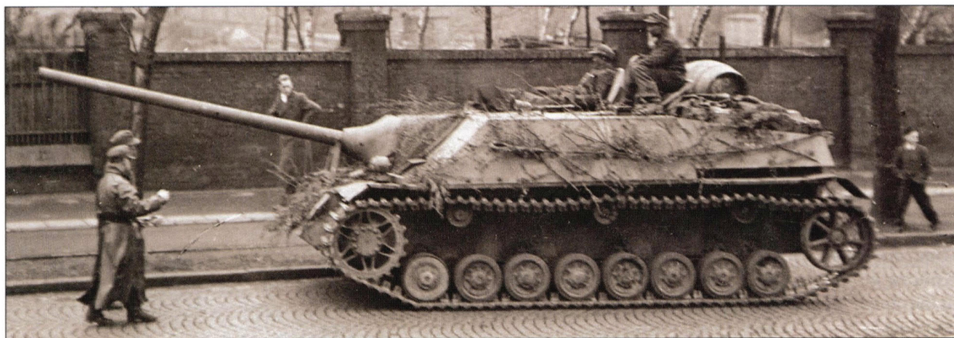
Немецкий танк-истребитель «Ягдпанцер IV» на базе Т-IV – передний каток выполнен без резинового бандажя
