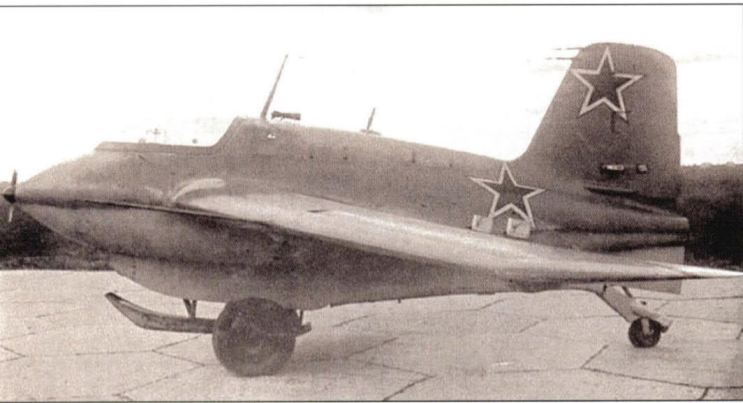
Трофейный Me-163 во время испытания в нашей стране. Самолет стоит на колесной тележке, опираясь на нее посадочной лыжей
