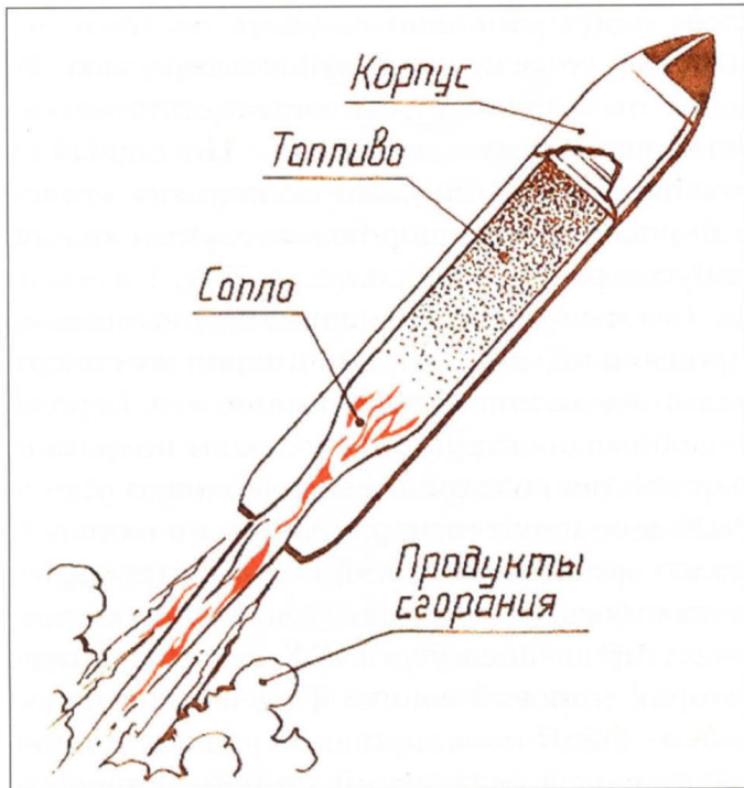
Устройство обычной пороховой ракеты
