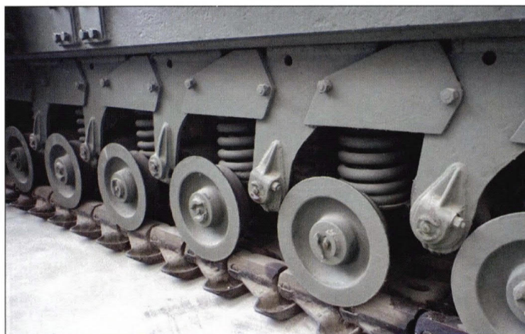
Британский тяжелый танк «Черчилль» с пружинной рычажной подвеской
