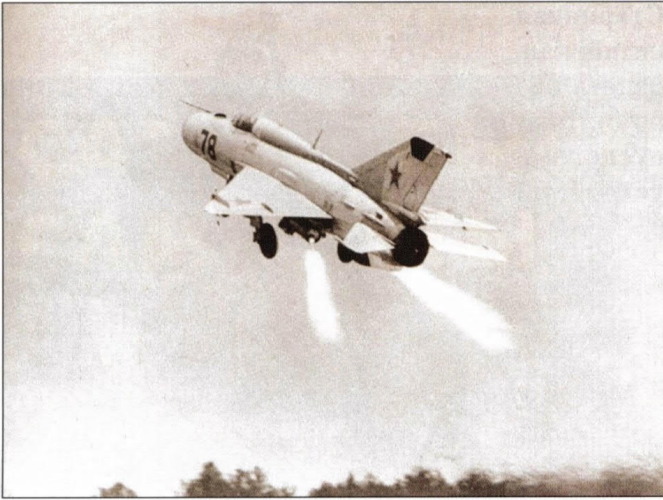
Взлет истребителя МиГ-21 с помощью двух стартовых пороховых ускорителей
