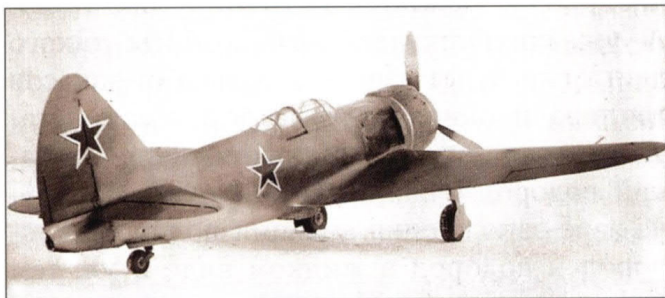
Истребитель Ла-7 с дополнительным жидкостным ракетным двигателем в хвостовой части фюзеляжа
