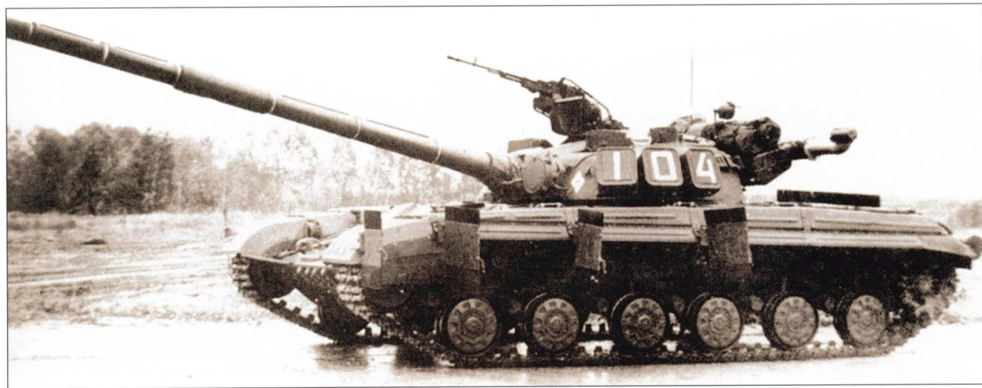
Танк Т-64 с катками малого диаметра
