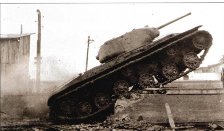
Тяжелый танк КВ с торсионной подвеской
