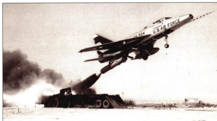
Запуск с помощью порохового ускорителя американского истребителя F-100
