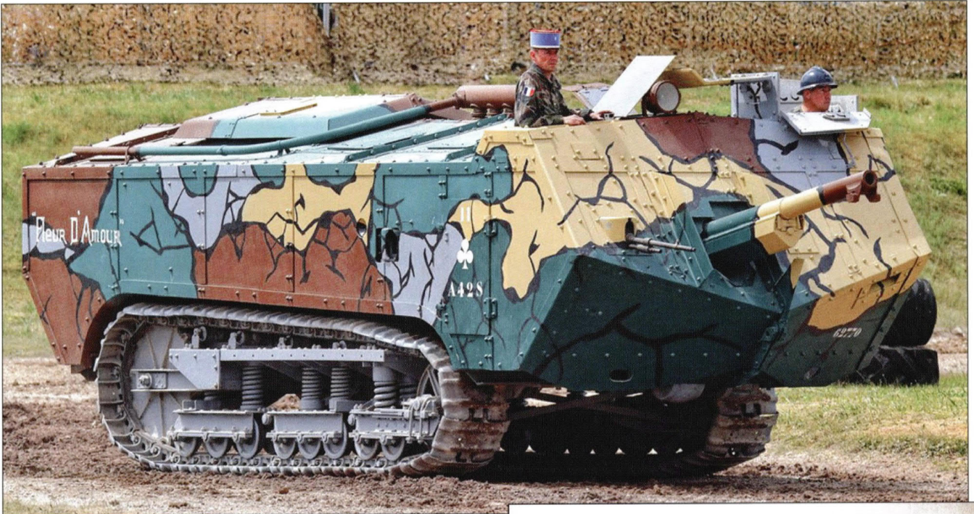
Восстановленный французский танк «Сен-Шамон». Обратите внимание на его пружинную подвеску
