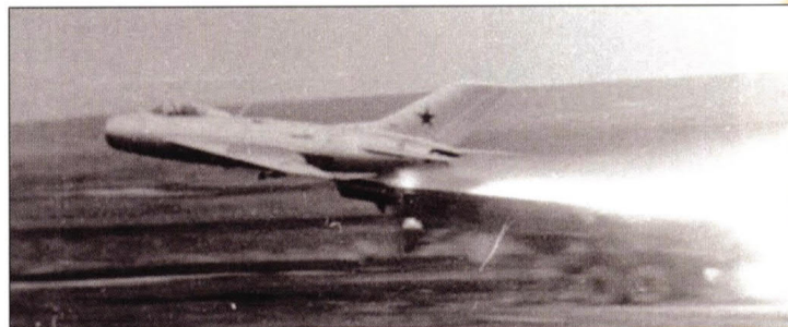
Самолет СМ-30 стартует с помощью пороховых ускорителей
