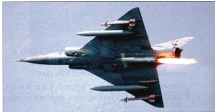
Дополнительные жидкостные ракетные двигатели в 1950-е годы пытались использовать на истребителях-перехватчиках для увеличения скорости и высоты полета, но распространения они не получили. На фото истребитель «Мираж» III французского производства
