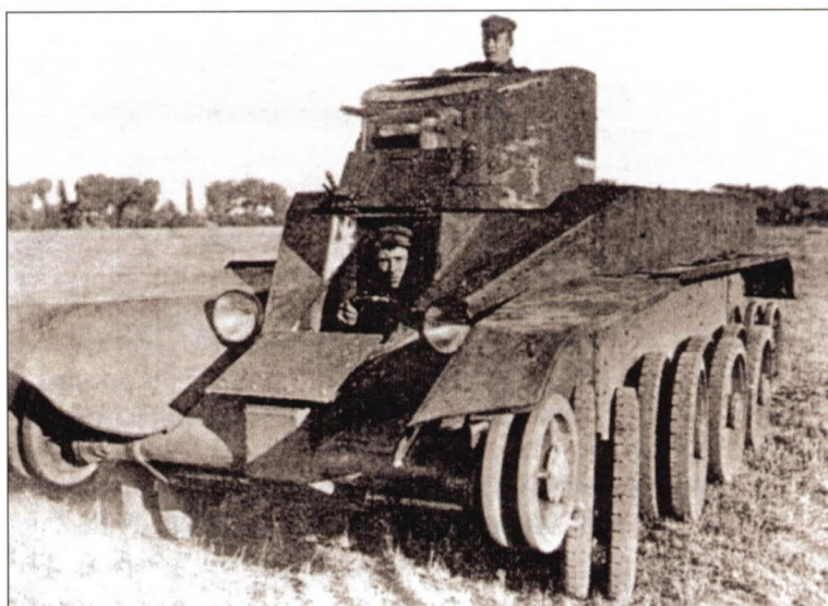
Колесно-гусеничный танк БТ-2 со снятыми гусеницами. На снимке видно, что передняя пара колес – управляемая
