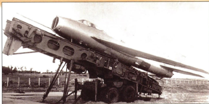
Самолет СМ-30 на пусковой установке «нулевого старта»
