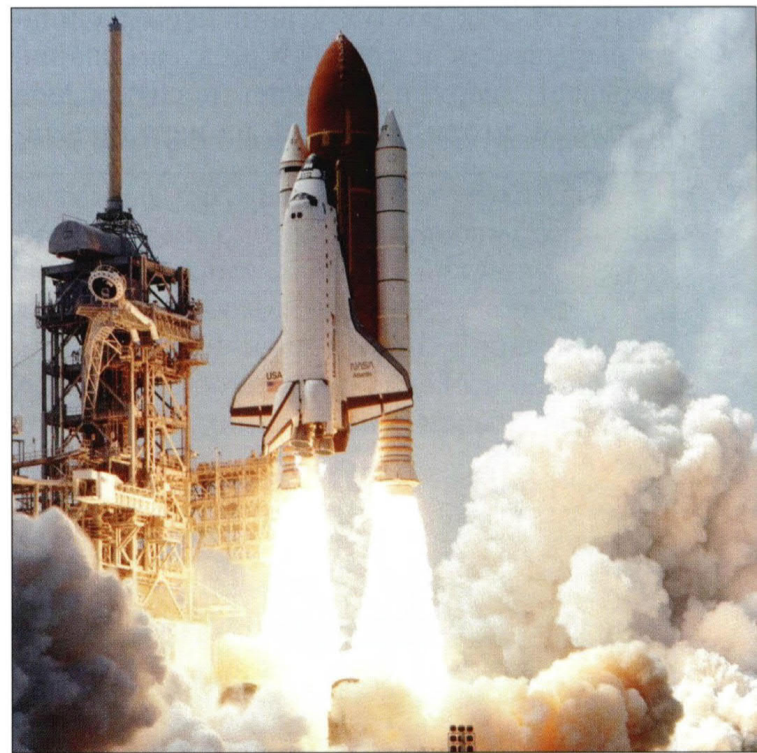
Запуск космического корабля «Спейс-Шаттл» при помощи двух твердотопливных ускорителей, установленных по бокам топливного бака
